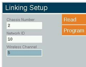
7. Прокрутите до пункта **Program** («Программа») и нажмите на колесо прокрутки. В нижней части экрана появится сообщение «Assignment Succeeded» («Привязка выполнена успешно»). В случае ошибки привязки повторите процесс.
